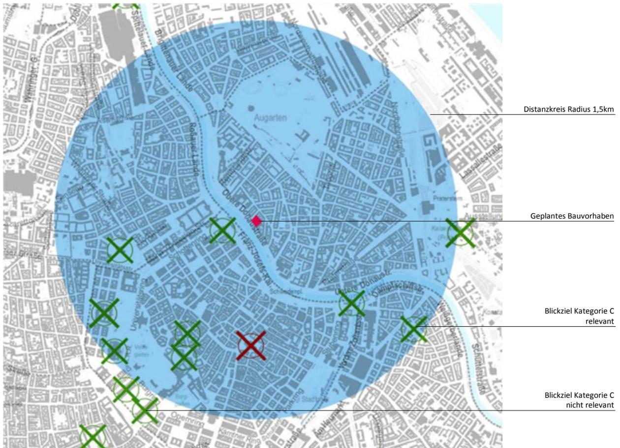
Abb. 21: Beispiel Distanzkreis 1,5km. Quelle: MA41, Bearbeitung ARGE BWM Feller Tabor
